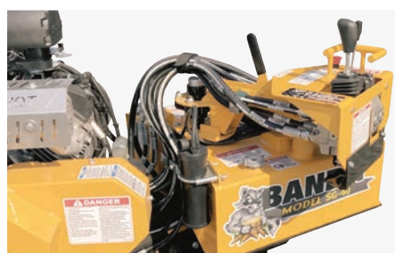
Poste déporté avec joysticks à commande proportionnelles.
