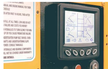
Système de régulation automatique de l'alimentation.
