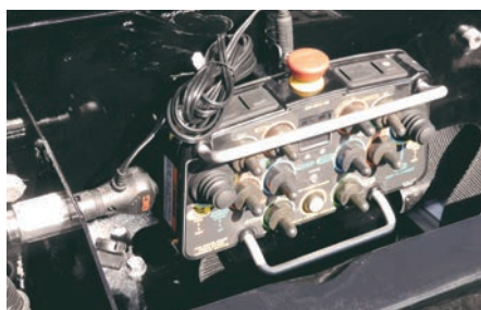
Radio commande de série avec prise de recharge 12 V intégrée à la rogneuse.
