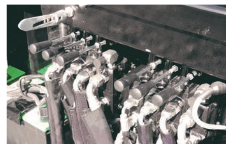
Télécommande filaire et commandes hydrauliques manuelles de série.
