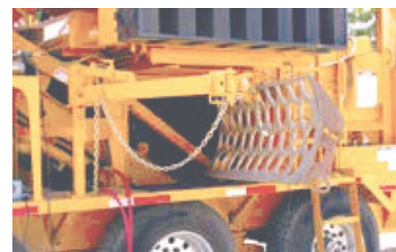
Grâce à plusieurs grilles de calibrage, le broyat est homogène et à granulométrie variable.
