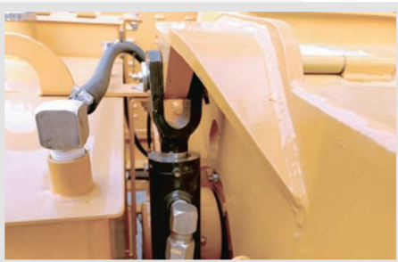
Un vérin hydraulique, de série, exerce une pression supplémentaire sur l'unique rouleau.
