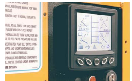
Système de régulation automatique de l'alimentation.
