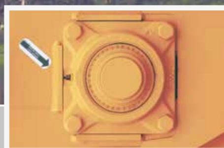
Roulements imposants et de qualité. Accès facile aux graisseurs.
