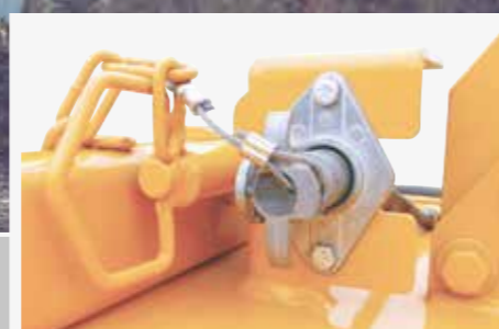
Accès au disque rapide et sans outil, avec 2 sécurités : une électrique et l'autre mécanique.
