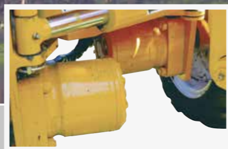
Les versions 4x4 sont dotées d'un moteur hydraulique sur chaque roue pour une meilleure motricité.
