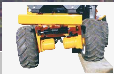
Les versions avec roues bénéficient d'essieux oscillants garantissant une meilleure stabilité.
