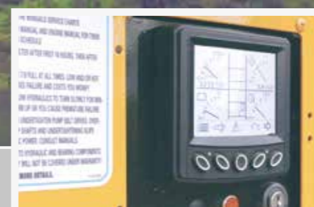
Système de régulation automatique de l'alimentation.
