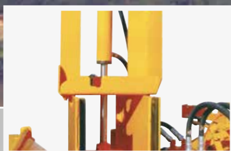
Un vérin hydraulique exerce une pression de 800 kg sur le rouleau supérieur d'alimentation.
